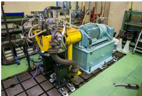
3 分力法を用いた浮動ライナー単気筒エンジンと原理図
