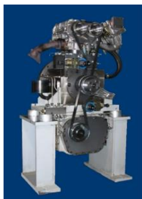
ピストン摩擦力測定装置 ”浮動ライナー” (2)(3)
