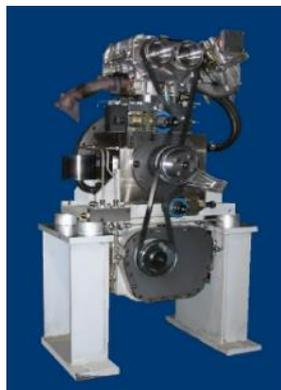
ピストン摩擦力測定装置
