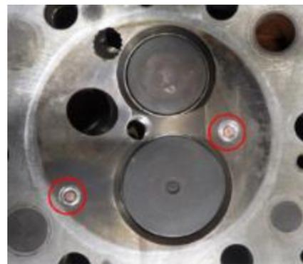
熱流束センサの形状及びシリンダヘッドへの埋め込み例
